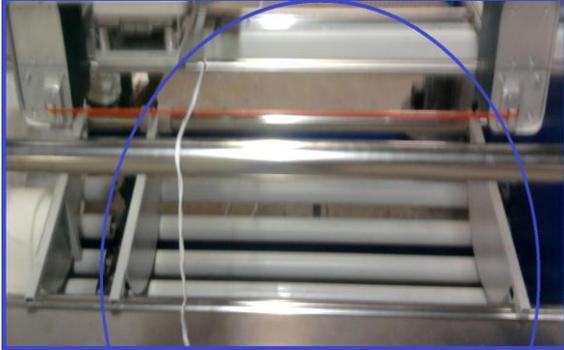
**Com o cocho de cilindros livre facilita o desenrolamento sem maltratar a malha evitando estiramento.**
