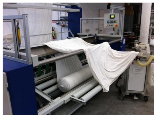
Cilindros motorizados auxilia no cocho de desenrolamento, de modo a minimizar a tensão da malha durante o curso.
