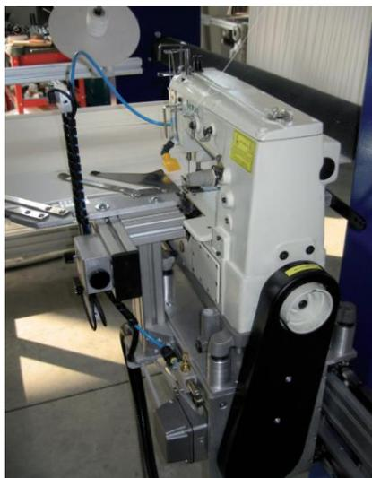
Máquina para costura de malhas de aberto para tubular elástica ou não, novo conceito com um sistema de dobras e alinhamento Patenteado que elimina o tradicional triângulo dobrador e permite precisa e contínua costura, sem defeitos causados pela ponta do triângulo, com controle de costura detector de falha de costura, dispositivos e equipamentos que permitem um tratamento totalmente automático sem a presença do operador.
