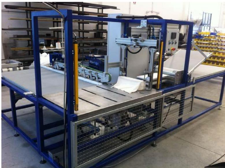
Máquina que permite o preenchimento da fronha com subseqüente fechamento da costura. O revestimento de fronha é introduzido automaticamente por um sistema injetor e outro de abertura da fronha para facilitar a entrada da espuma de LATEX.
