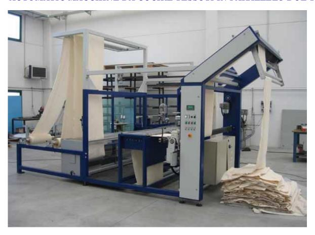
Máquina usada para unir dois ou mais tecidos dos mesmos ou diferentes larguras, de modo a formar uma única folha e otimizar as fases de processamento subsequentes, tais como o tingimento e acabamento. A grande vantagem deste sistema é a possibilidade de dobrar / triplicar a produtividade por meio da otimização de custos. O alinhamento perfeito das duas ou mais folhas e costura nas procimidades das ourelas
